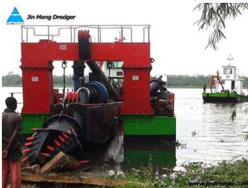
Tàu nạo vét hút JMD650 Cutter với động cơ Cummins
