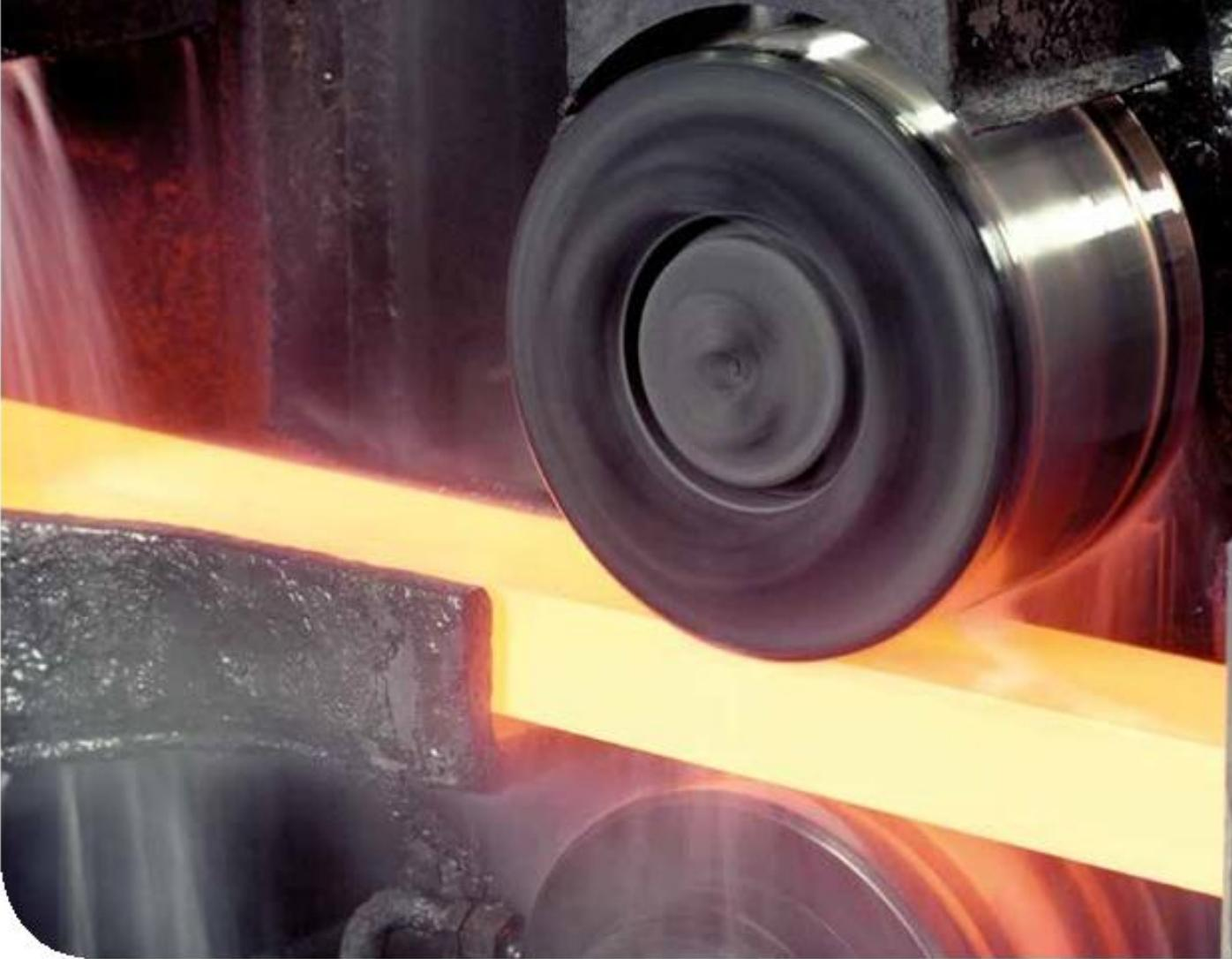
wie bei der CONTIROD® in einem kontinuierlichen Prozessablauf. Verwendung findet das Band in der Rohrindustrie: Es kann entweder zu einem Mutterrohr geformt und geschweißt oder für die Herstellung von innenberippten Wärmetauscher-Rohren (ACR) genutzt werden. In diesem Fall wird das Schmalband bis auf Enddicke kaltgewalzt.
