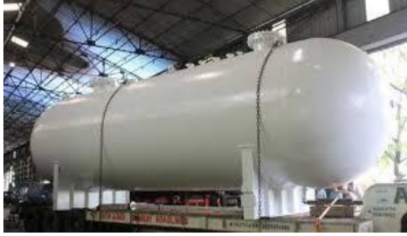
Hệ thống tích Biogas
